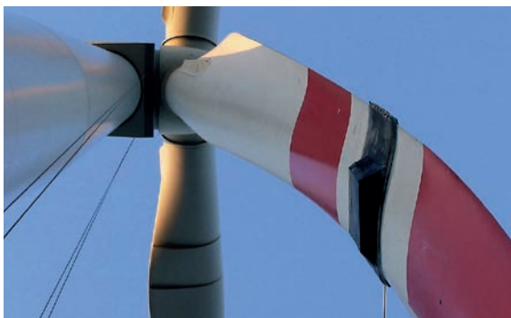
Der aerodynamische Handschuh wurde für die Messungen an einem der drei Rotorblätter der Windkraftanlage in Eggebek montiert.
