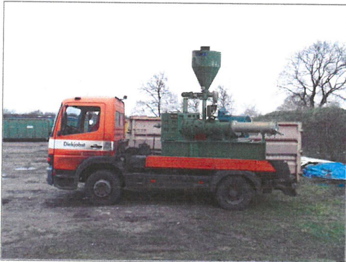
Abbildung 5: Prototyp zur Applikation von Stärkeschaum auf Fahrsilos als Hakenliftvariante zur Verwendung mit unterschiedlichen Trägerfahrzeugen (LKW) im Herbst 2015
