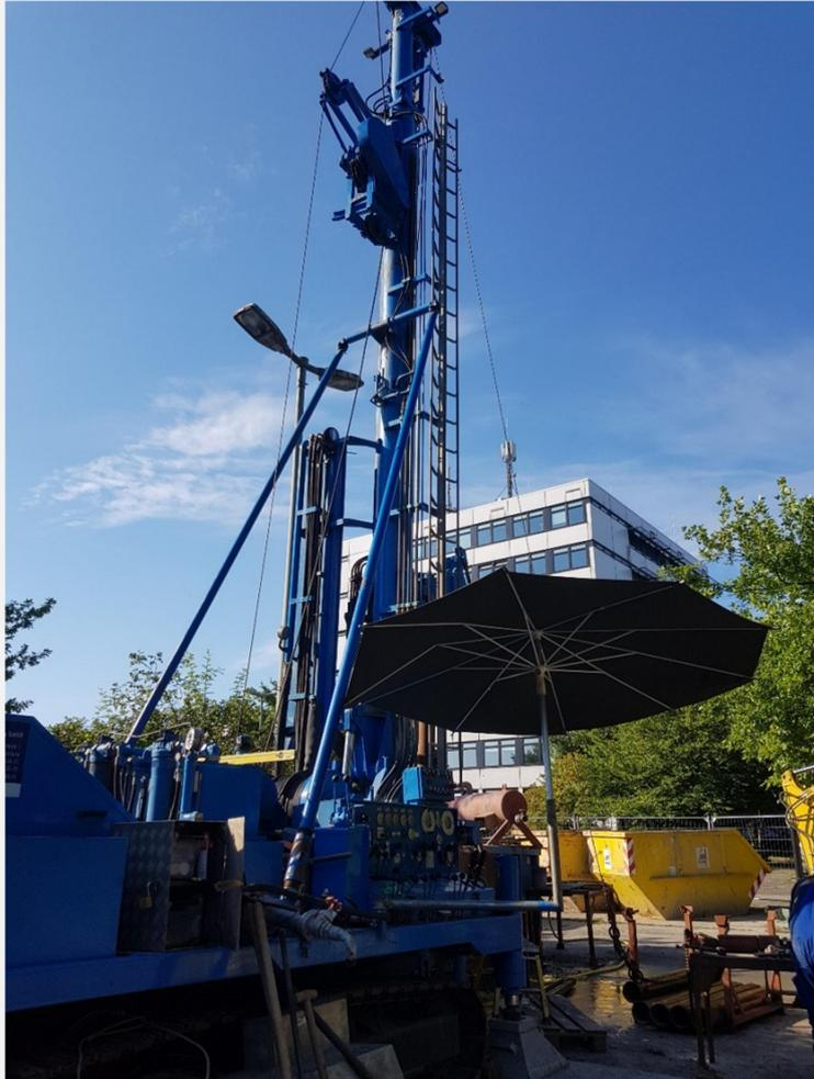
Abbildung 6: Verwendetes Drehbohrgerät DSB 2/7 Raupe
