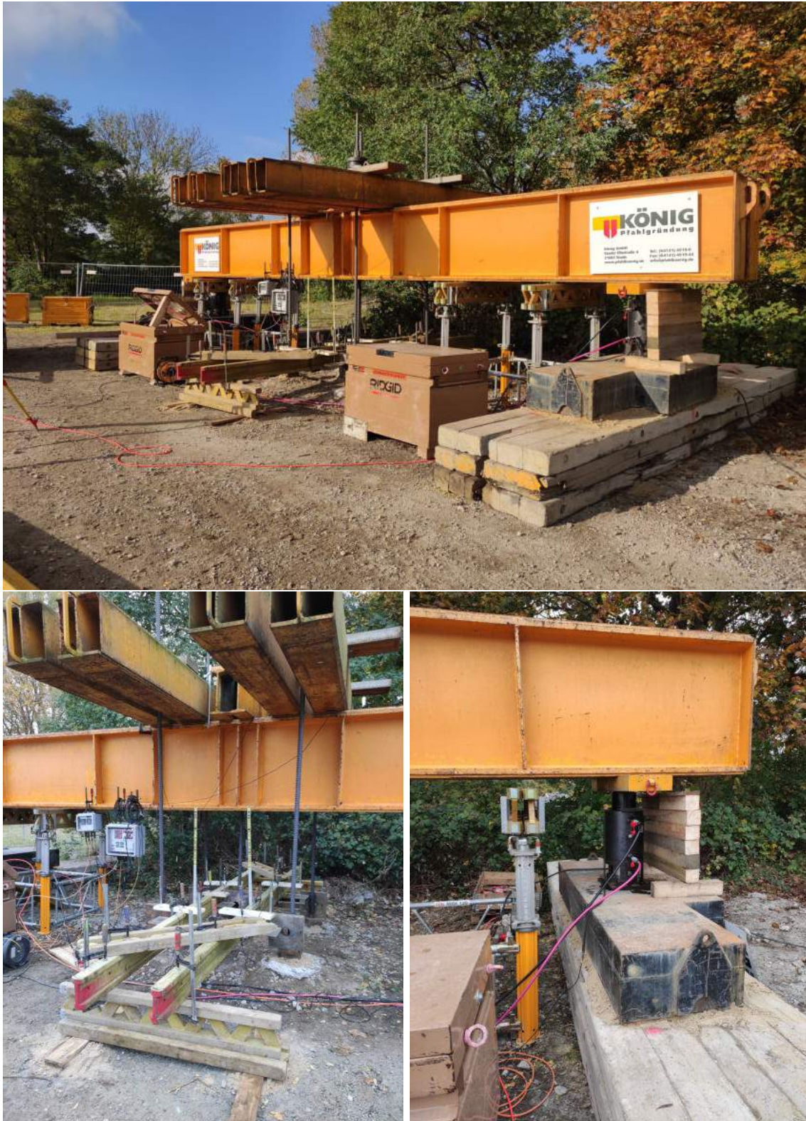
Abb. 8.11: Fotos des Versuchsaufbaus der Pfahlgruppe
