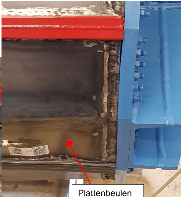
Abbildung 17-8: Beul- und Längsschubversagen beim modularen Prüfkörper „Pharos I, gesteckt“
